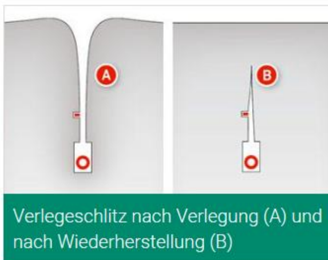
Abbildung 8: Schematischer Querschnitt einer Kabelverlegung durch Pflug 4
