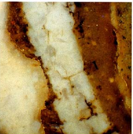
Laborbefund: Farbschichten auf Stein, drei nachfolgende Vergoldungen auf Bleiwerggründierung
